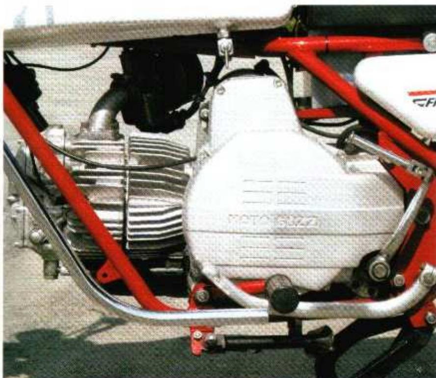
in bagno d'olio. Ad alimentare l'impianto elettrico a 12 volt provvede una batteria da 13 Ah alimentata da una dinamo da 150 watt, azionata da una cinghia trapezoidale che prende il moto da una puleggia ricavata sul volano.
